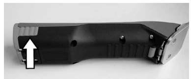
Fig. 7 Verrouillage de batterie
