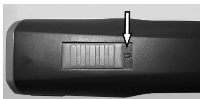
Fig. 4 Interrupteur position arrêt (« 0 »)
