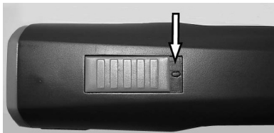
Abb. 4 Schiebeschalter in AUS-Position („0“)
